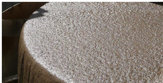
图1 用于粗颗粒回收的 Eriez HydroFloat 法
